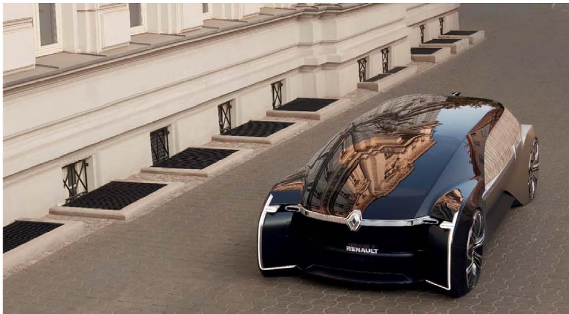
spazio confortevole ed accogliente, con una serie di servizi premium che cominciano fin dal momento in cui si effettua la prenotazione, con un'interfaccia esclusiva e personalizzata. Lunga 5,70 metri, ha un passo di 3,88 metri ed è dotata di un gruppo motopropulsore elettrico con ricarica a induzione e sospensioni attive.
