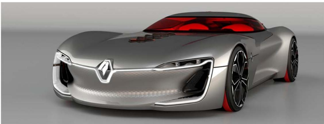
Con TREZOR, Renault già opta per la digitalizzazione dell'abitacolo, a cui si può accedere senza aver bisogno delle porte, grazie al tetto inclinabile. È dotata di motore elettrico da 257 kW (350 cv) per un peso totale di 1.600 kg, mentre la carrozzeria vanta un coefficiente di penetrazione aerodinamica (Cx) di 0,22.
