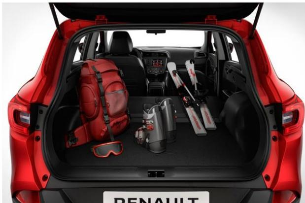
La modularità interna è facile e intuitiva. Grazie a maniglie situate nel vano bagagli, il sistema “Easy Break” consente di sbloccare e ripiegare automaticamente i sedili posteriori con funzionalità 1/3-2/3. Inoltre, il sedile passeggero può essere ripiegato in posizione tavolino grazie ad una maniglia disposta nella parte inferiore del sedile, per consentire il carico di oggetti lunghi più di 2,5 metri.
